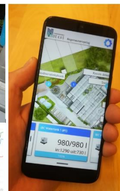
Sensor en app waarmee in- en uitlaat van regenwater worden bepaald
